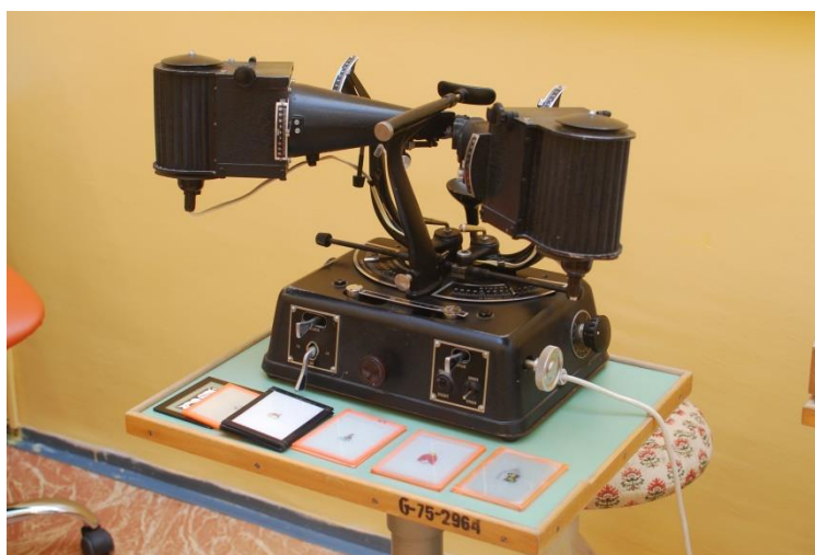
Obr. 16 – Troposkop s obrázky pro vyšetření stereopse, fúze a superpozice
