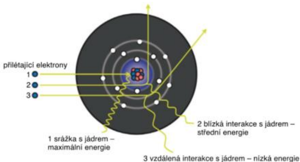
Obrázek 1 – Schematické znázornění vzniku brzdného záření (Zdroj: Malíková et al., 2019)
