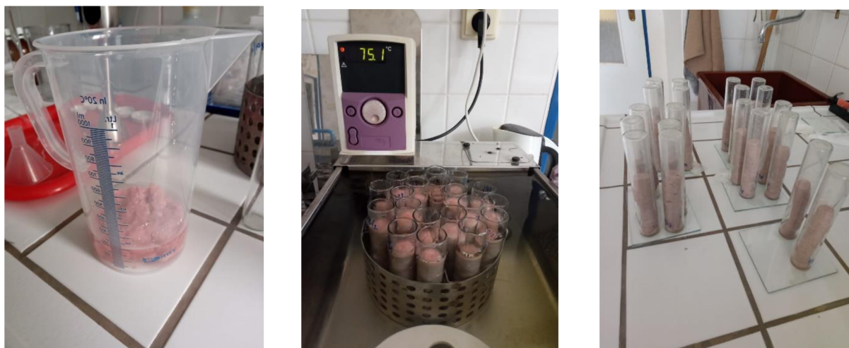
Obr. 8 – 10 – Stanovení vaznosti jednotlivých vzorků (zleva: homogenizace, zahřívání ve vodní lázni a vzorky po stanovení před finálním vážením (foto autor DP)
