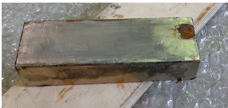
Obrázek 27: Magnet vytažený z válcové trysky po provedení experimentu.
