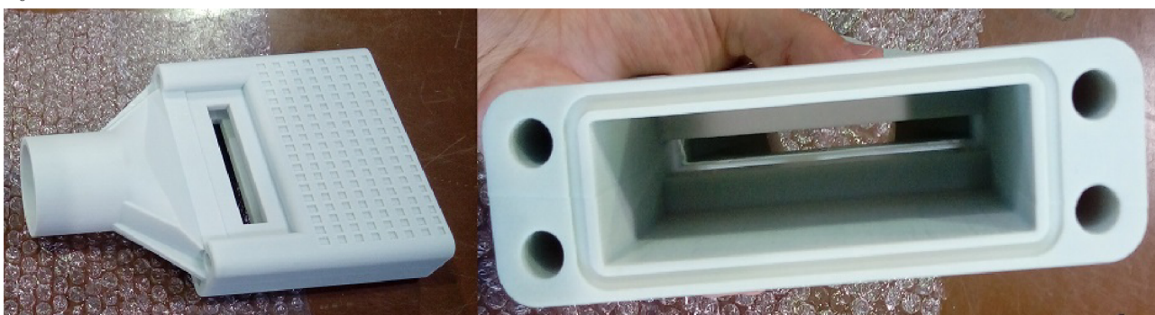
Obrázek 38: Větší část ploché trysky, vyrobeno na 3D tiskárně
