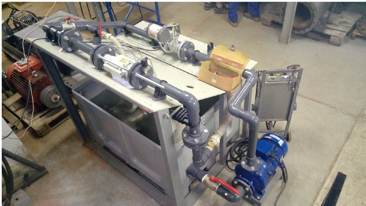
Obrázek 34: Hydraulická trať obsahující plochou kavitační trysku s permanentními magnety.
