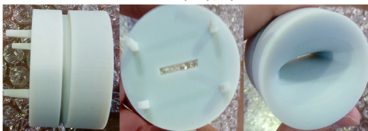
Obrázek 21: Menší část válcové trysky, vyrobeno na 3D tiskárně z materiálu Polyjet
