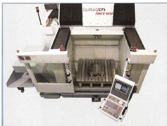
Obr. 5.52 Přístup do pracovního prostoru, možnost manipulace s obrobkem pomocí jeřábu (9)
