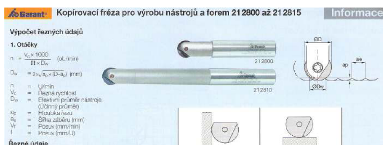
Obr. 4.21 Data pro výpočet řezných údajů pro kopírovací frézu (5)
