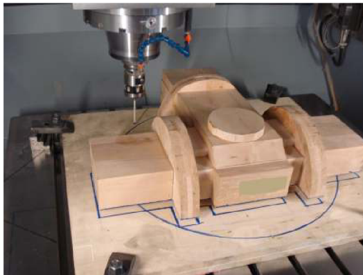
Obr. 5.60 Nastavení osy Z měřicí sondou
