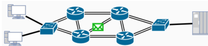
Obr. 9.2: Rezervovanie sieťových prostriedkov pri komutácií okruhov
