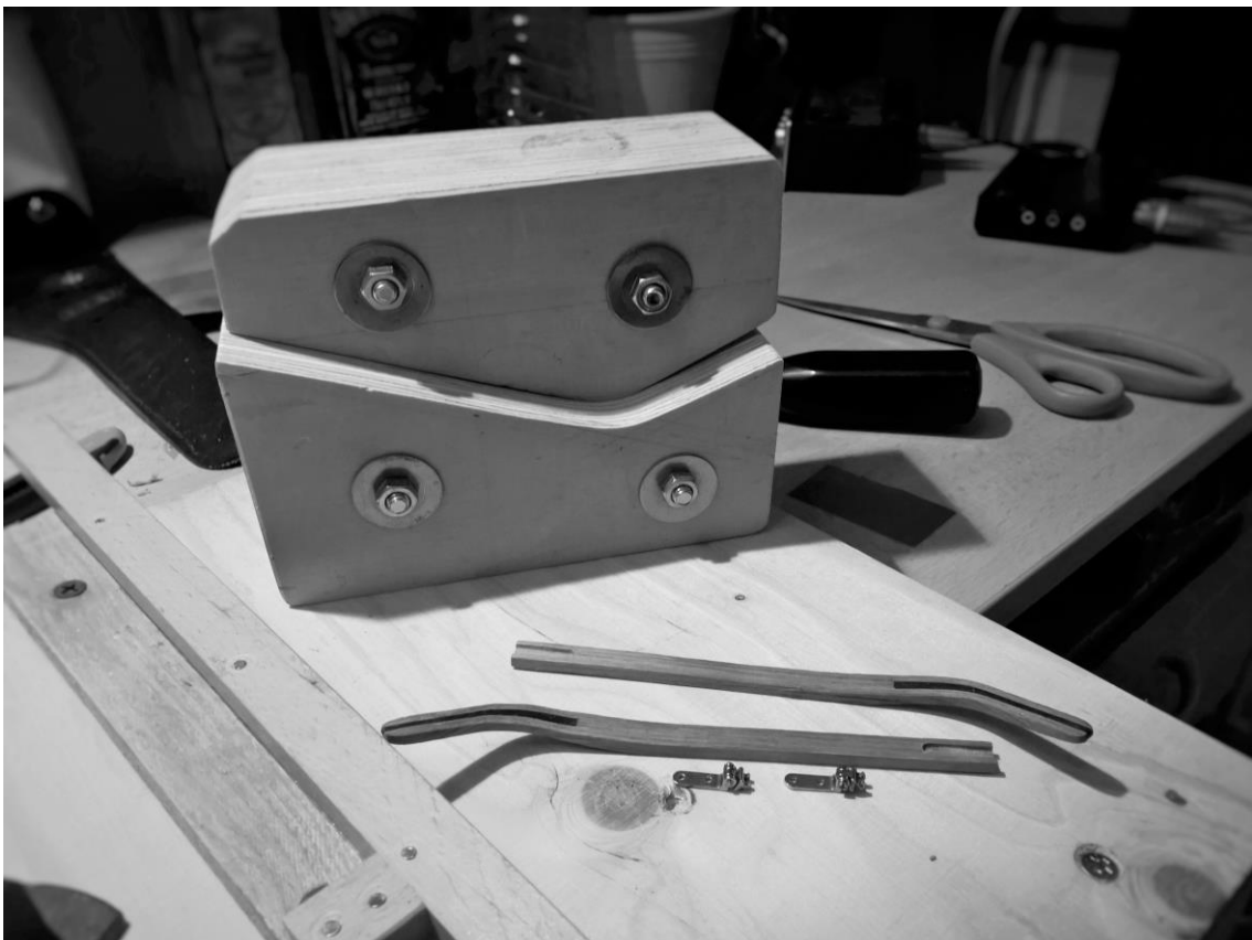
Obrázek 27 - Forma pro výrobu stranic
