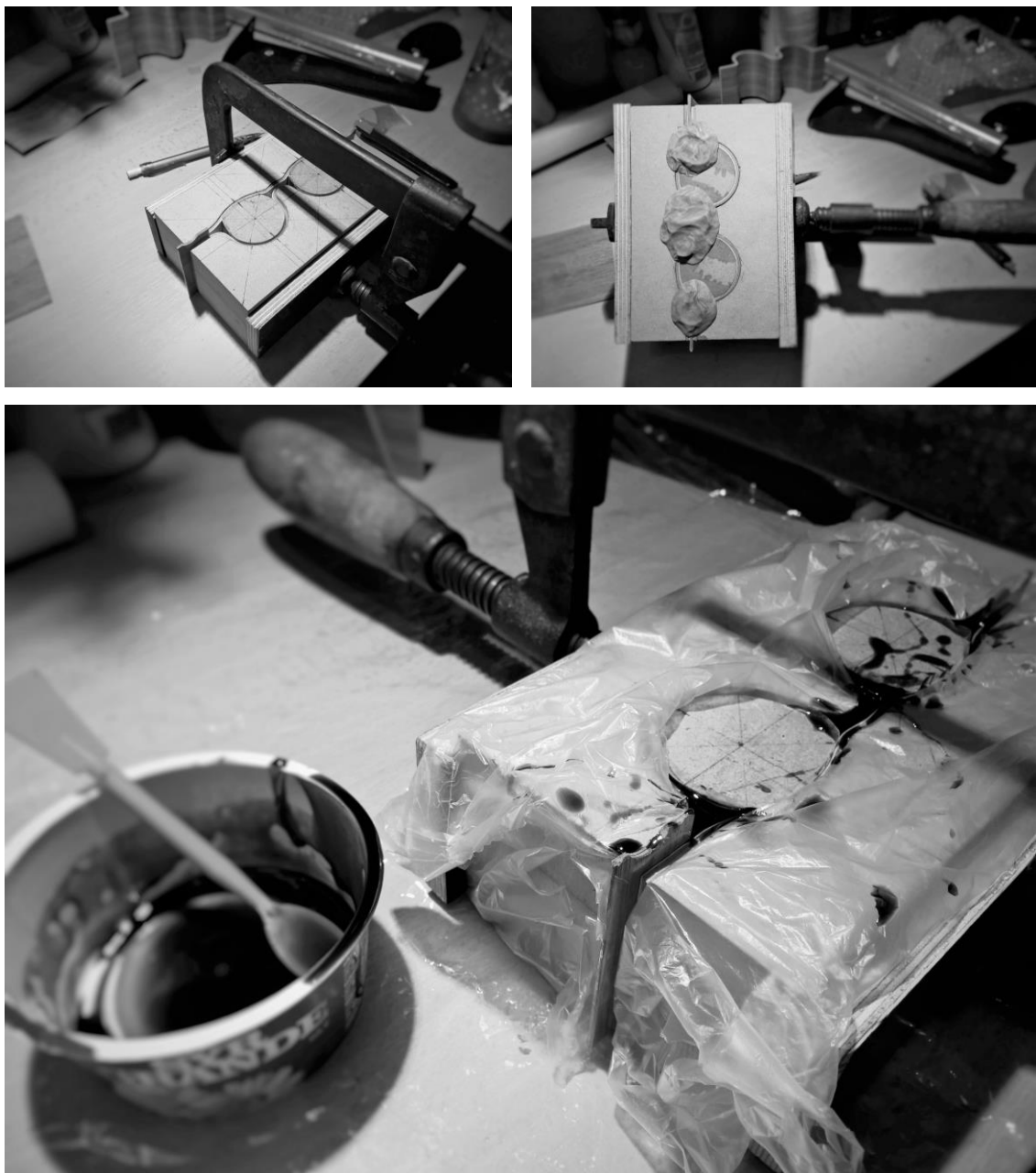
Obrázek 25 - Příprava formy a lití elastomeru
