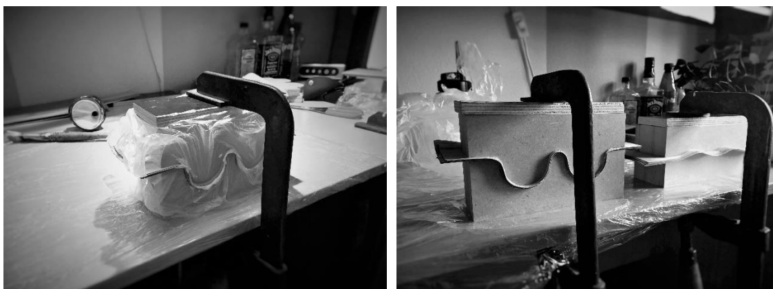
Obrázek 23 - Fixace zalisovaného souboru dých
