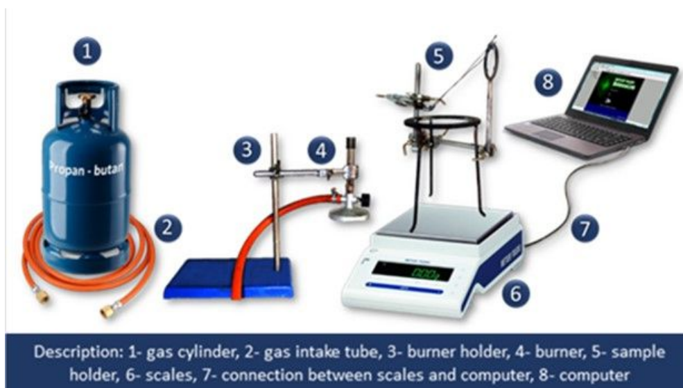
Obr. 11. Schéma zařízení na test hořlavosti podle ČSN (ČSN 73 0862, 2003)
