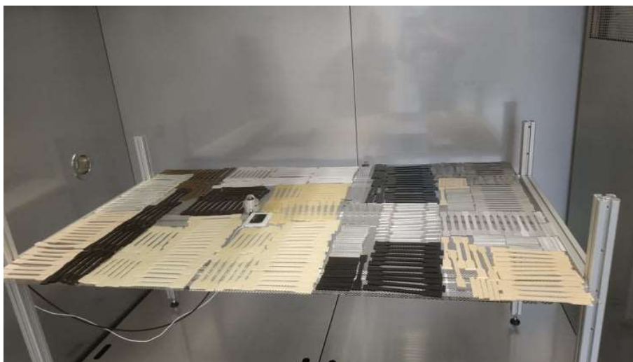
Obr. 14 Zkušební tělíska umístěná v solární klimatické skříni
