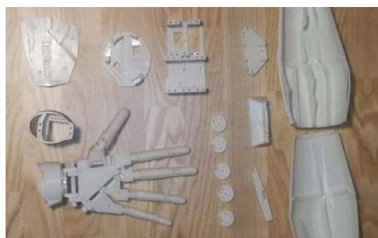
Obr. 5 Díly robota vyrobené z PLA [18]
