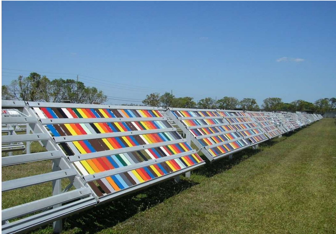
Obr. 8 Expoziční stanice pro přímé přirozené stárnutí polymerů [29]
