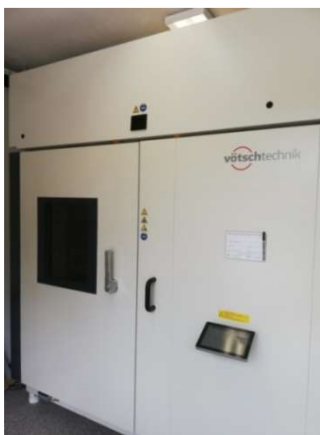
Obr. 13 Solární klimatická skříň SUN 3600 Vötsch
