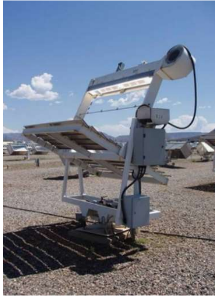
Obr. 9 Expoziční stanice pro zesílené intenzivní stárnutí polymerů použitím Fresnelových zrcadel dle ISO 877-3 [26]
