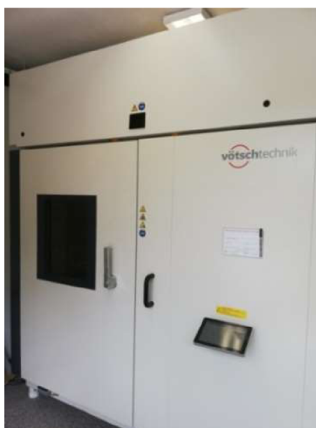
Obr. 13 Solární klimatická skříň SUN 3600 Vötsch
