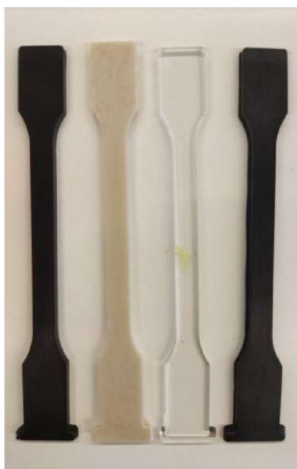
Obr. 11 Zkušební tělesa, zleva PP, PHBV, PLLA, PLA/PHB
