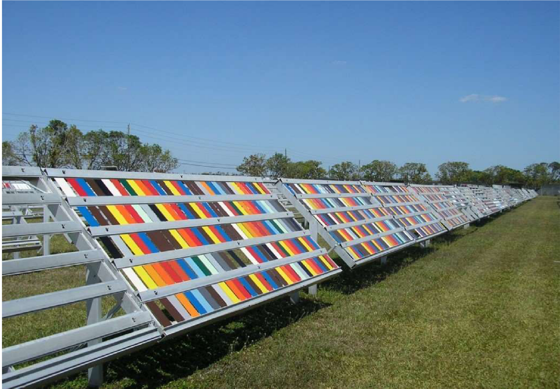
Obr. 8 Expoziční stanice pro přímé přirozené stárnutí polymerů [29]
