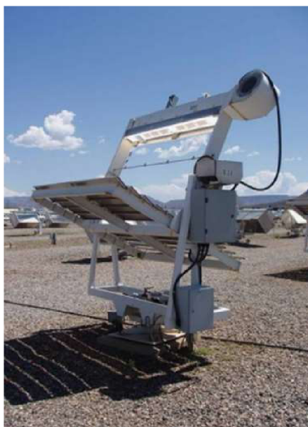
Obr. 9 Expoziční stanice pro zesílené intenzivní stárnutí polymerů použitím Fresnelových zrcadel dle ISO 877-3 [26]
