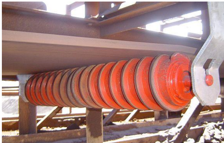
Obrázek 21 Spirální válečkový čistič [38]
