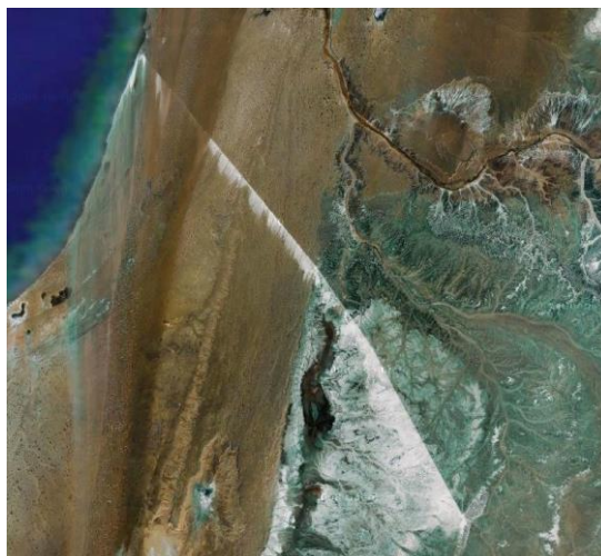
Obrázek 2 Fosfátová stopa dopravníku z dolu Bou Craa [21]
