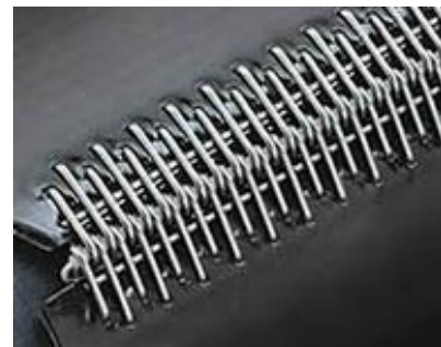
Obrázek 8 Spojení pásu pomocí háčků [24]
