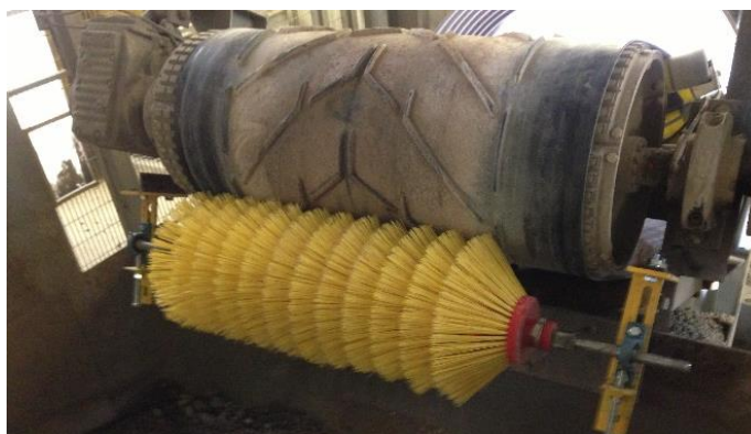
Obrázek 24 Kartáčový čistič pásu [40]
