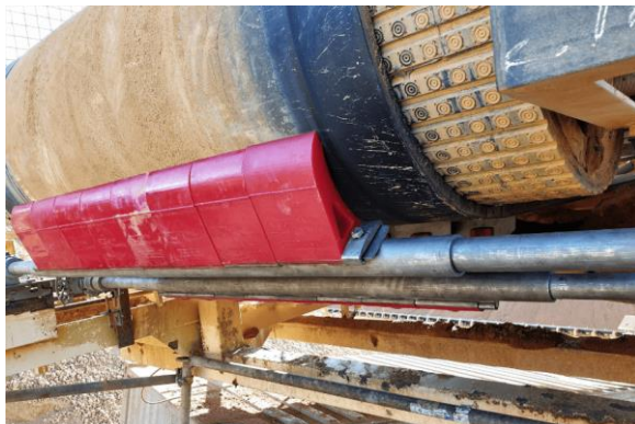
Obrázek 19 Polyuretanový segmentový stěrač [36]
