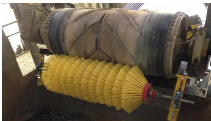
Obrázek 24 Kartáčový čistič pásu [40]
