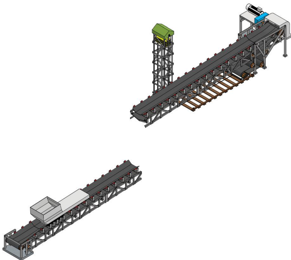
Obrázek 30 3D model navrhované koncepce [Autor]
