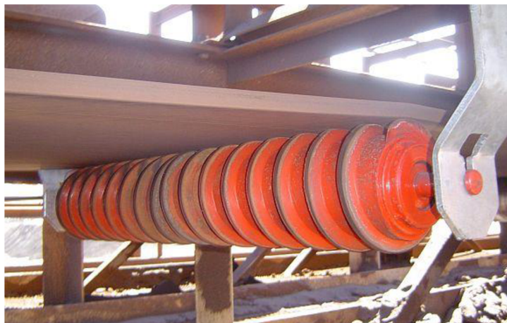
Obrázek 21 Spirální válečkový čistič [38]
