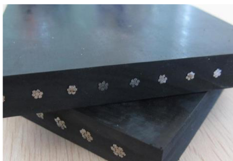
Obrázek 5 Dopravní pás s ocelokordovou kostrou [23]
