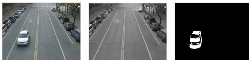
Obr. 5 Ukázka fungování odečítání pozadí [17]
