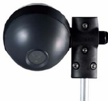
Obr 10 Kamrová jednotka systému Traficon [36]
