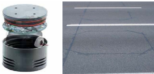
Obr. 1 Dvouosý magnetometr [22] a obr. 2 povrch vozovky s instalovanou detekční smyčkou [37].
