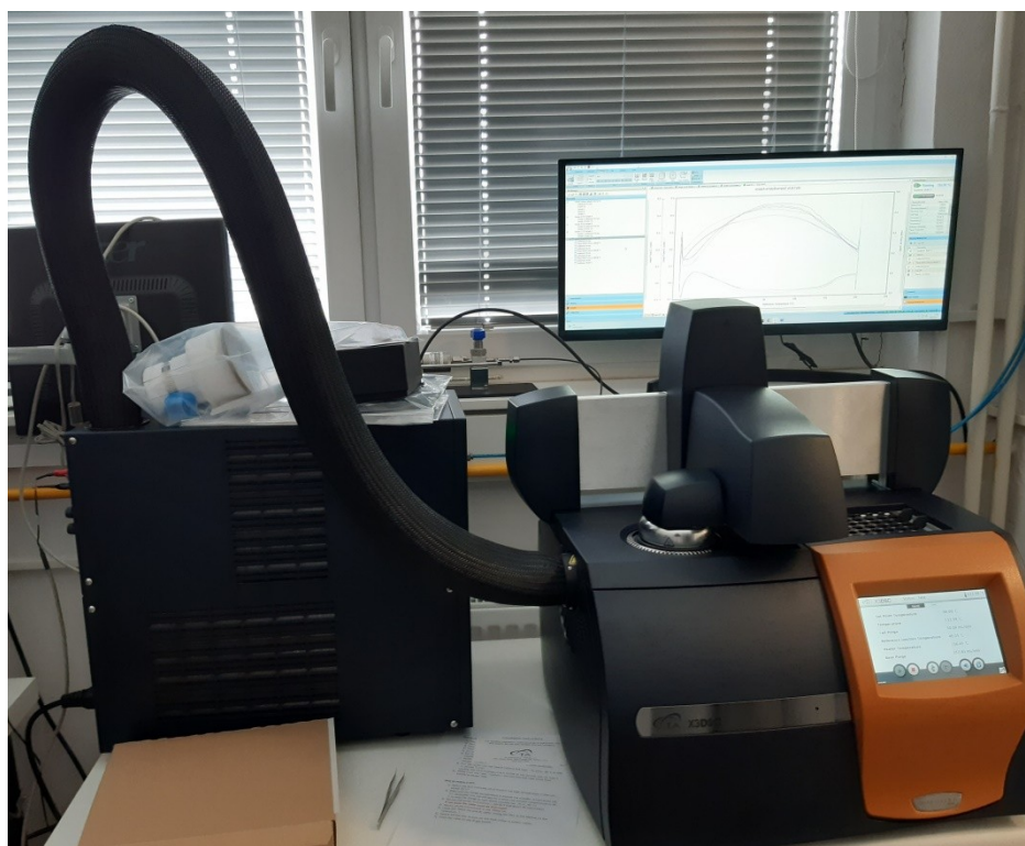
Obrázek 12 Diferenční skenovací kalorimetrie Discovery X3 DSC (autor práce)
