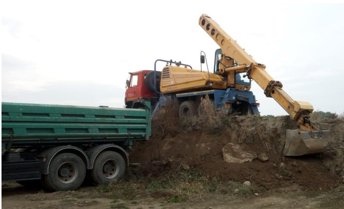
Obrázek 12 Činnost rýpání a nabírání horniny během měření časů pracovních cyklů – ve stavu před provedenou inovací hydraulického systému rypadla UDS 214
