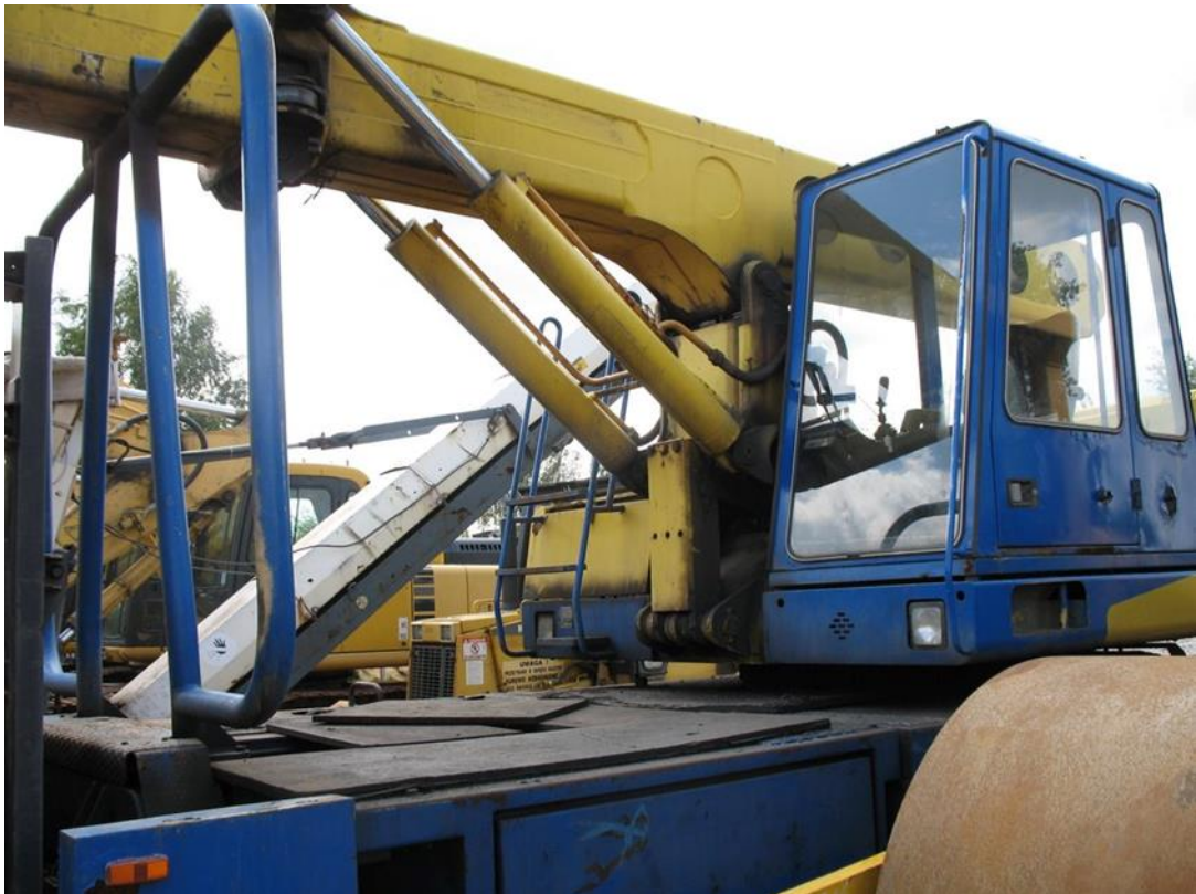
PO 2 Dvojice přímočarých hydromotorů (125/80/1000) pro zdvih výložníku
