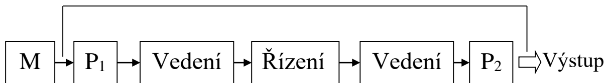
Obrázek 3 Blokové schéma funkce hydraulického obvodu
