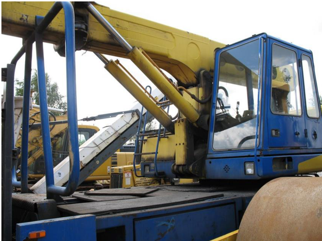
PO 2 Dvojice přímočarých hydromotorů (125/80/1000) pro zdvih výložníku
