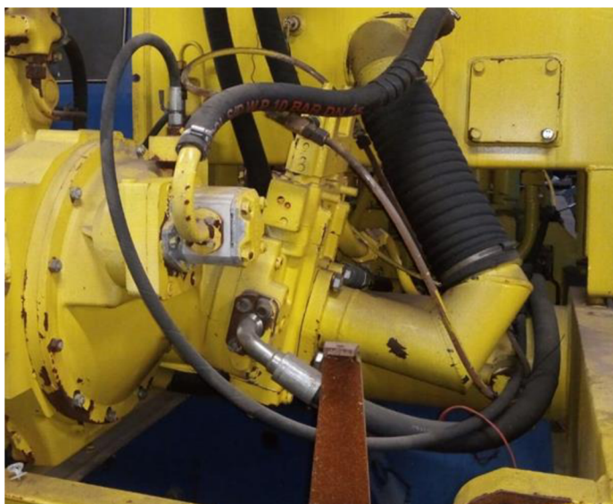
Obrázek 5 Axiální pístové dvoučerpadlo Bosch Rexroth A8VO107 teleskopického rypadla UDS 214 – před provedenou inovací hydraulického systému
