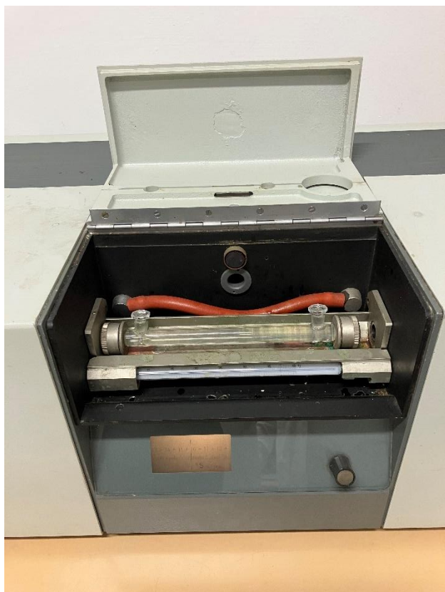
Obrázek č. 8: Měření v polarimetru (autor: Veronika Dobiášová)
