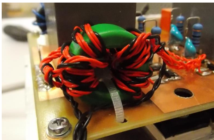
Obr. 4–5 Detailní fotografie budicího transformátoru
