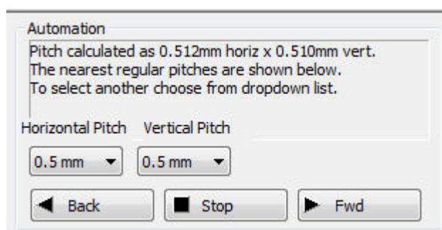
Obrázek 53: Měření a nastavení roztečí BGA (převzato z [11])
