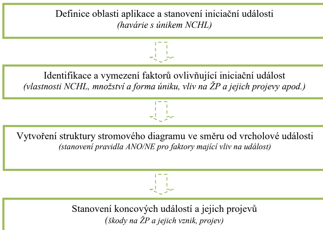
Obr. 29 Princip aplikace metody ETA zpracován dle zásad ČSN 62502 (010676)
