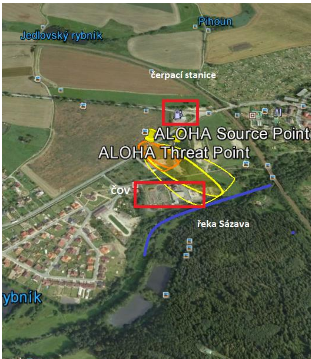
Obr. 50 Model havárie s únikem přepravované motorové nafty a vyznačením zranitelných prvků v zasažené zóně (U. S. EPA, 2016, Google Earth, 2016)
