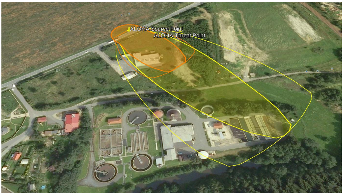
Obr. 47 Výstup modelování úniku motorové nafty při havárii na pozemní komunikaci (U. S. EPA Aloha 5.4, 2016, Google Earth 2016)
