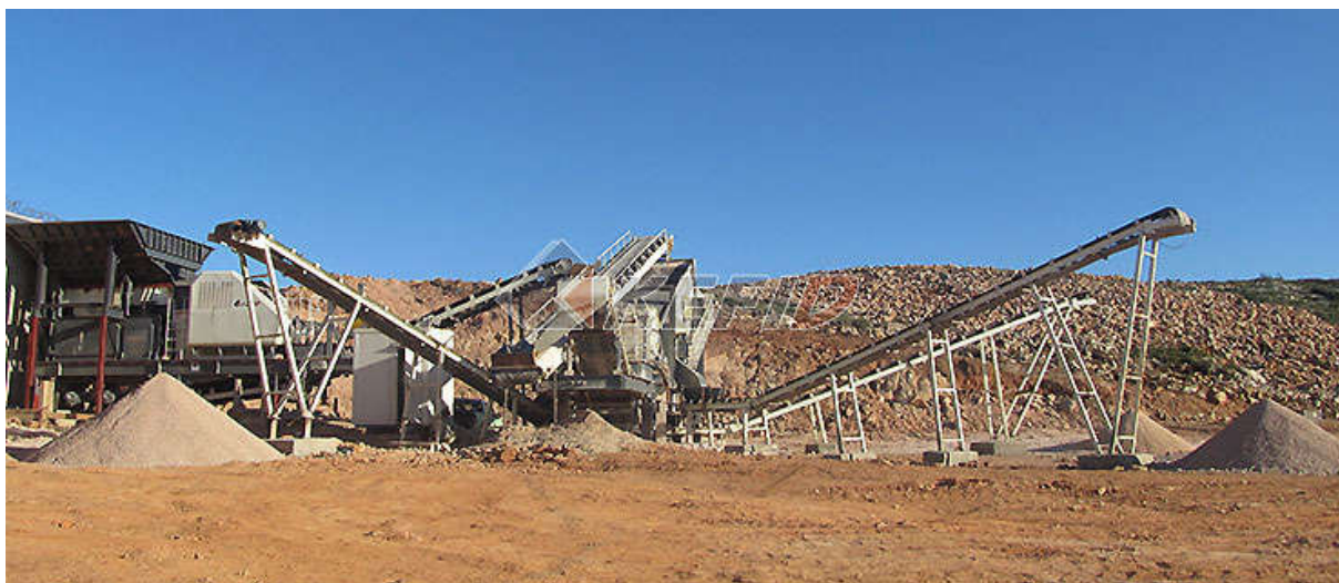
Obr. 27 Mobilní vápencová drtička se čtyřmi pásovými dopravníky [23]
