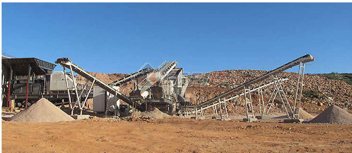
Obr. 27 Mobilní vápencová drtička se čtyřmi pásovými dopravníky [23]
