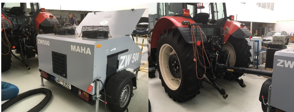
Obr. 11 Dynamometr MAHA ZW-500 a ukázka napojení na vývodový hřídel.
