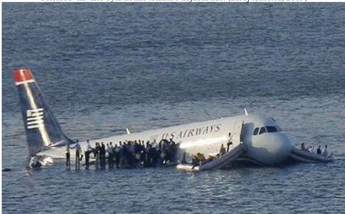
Obr. 1. Airbus A-320 se 155 lidmi na palubě po nouzovém přistání na řece Hudson. Příčinou havárie byla kolize letadla s hejnem hus. (zdroj idnes.cz, 2009)
