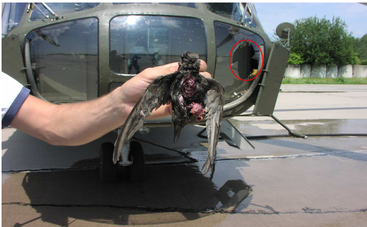
Obr. 25. Poškození bočního skla kokpitu vrtulníku po střetu s rorýsem obecným (Gallat,2009)
