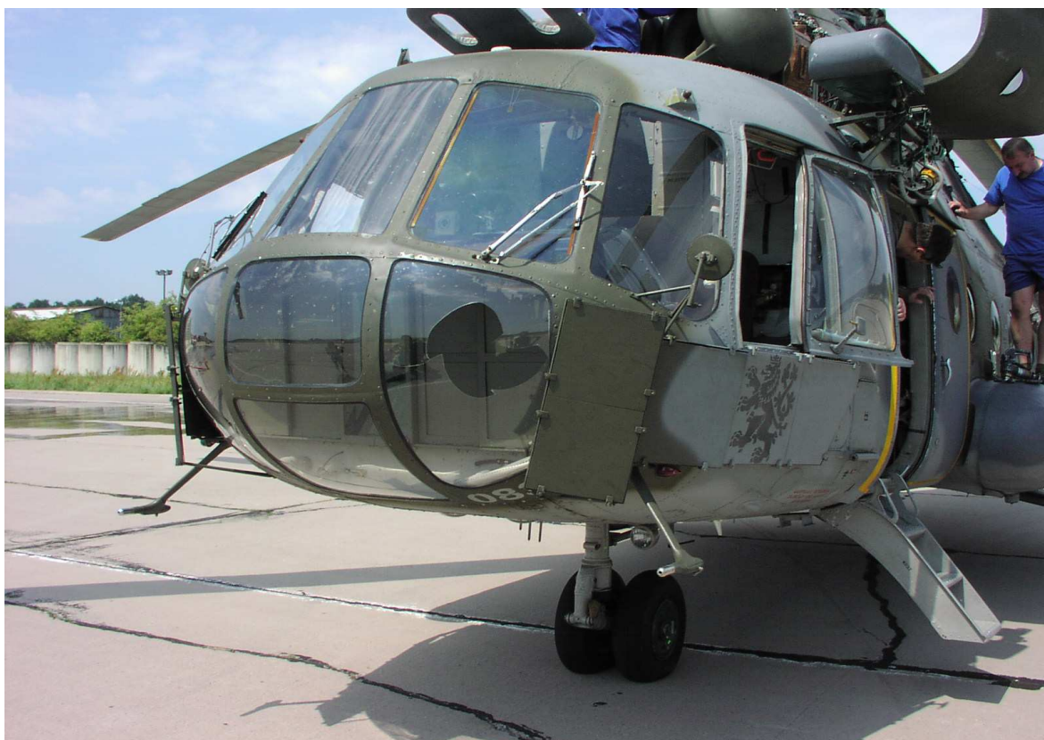
Obr. 26. Poškození bočního skla kokpitu vrtulníku po střetu s rorýsem obecným (Gallat, 2009)
