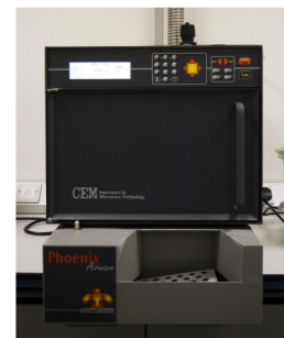
Obr. 2.9 Pec na spalování vosku
