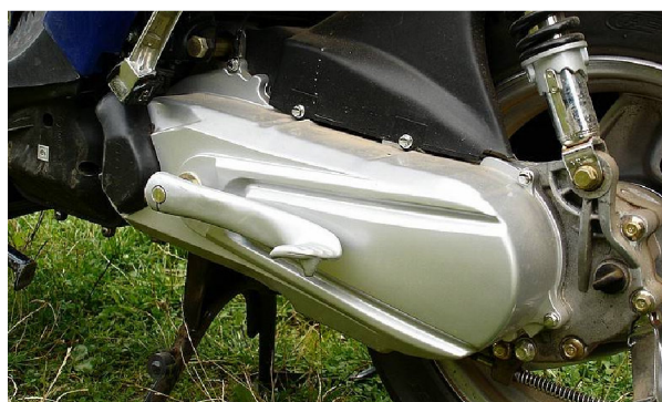
obr. 12. detail variátoru u skútru Kentoya Zoom 2
