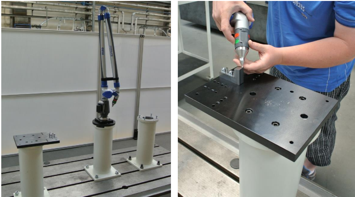
Obr.30 Meranie kontúry mobilným meracím ramenom FARO.
