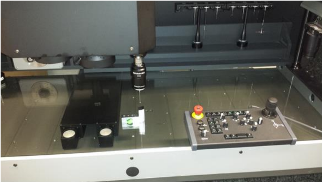
Obr.29 Meranie kontúrového kusu prístrojom Werth-VideoCheck IP 1250 - pohľad na merací stôl.
