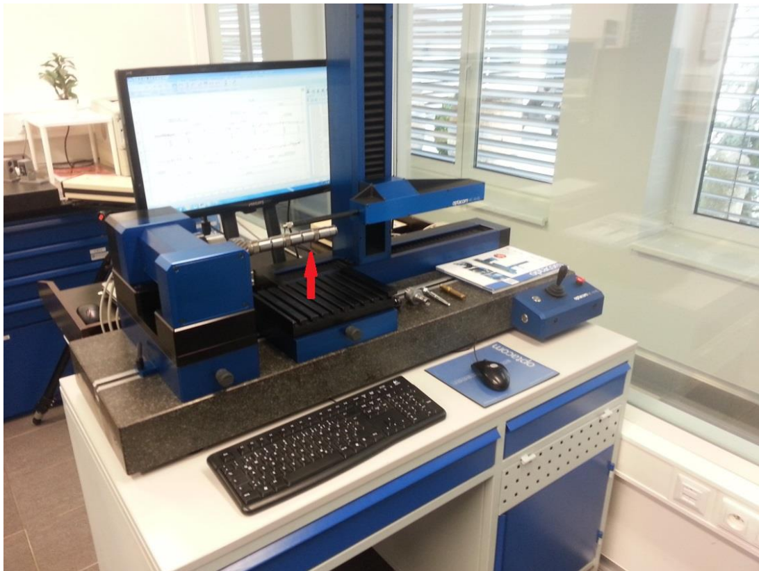
Obr.25 Meranie hriadeľa na stroji OPTACOM VC-10-EL
