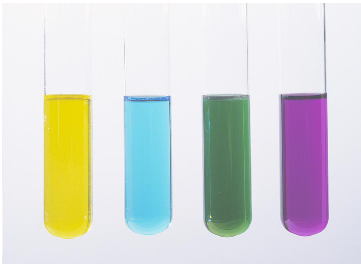
Obr. 1.3: Oxidační stavy vanadu. Zleva \text{VO}_2^+ , \text{VO}^{2+} , \text{V}^{3+} a \text{V}^{2+} [9]
