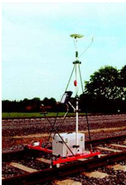
Obrázek 1: GNSS RTK Data kolektor – GNBAHN [27]
