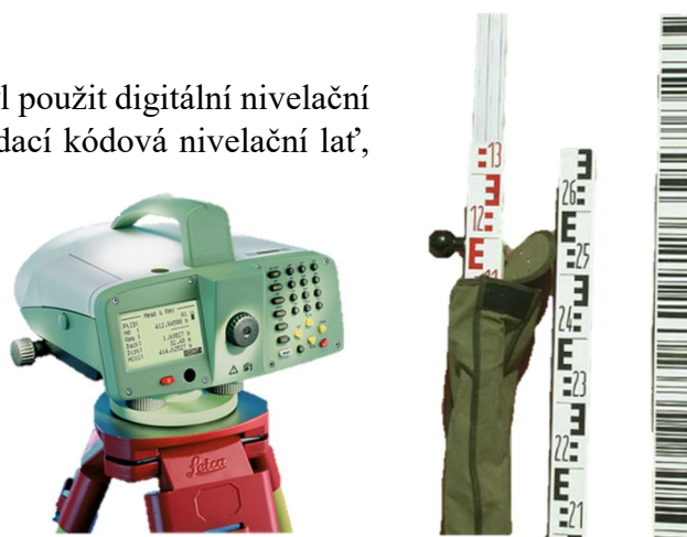
Obrázek 28: Leica DNA03 + laminátová skládací lať [36]
