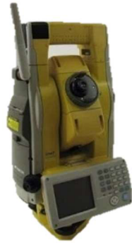
Obrázek 33: Topcon GPT-9003A [38] + Měřicí vozík GG-04 [39]
