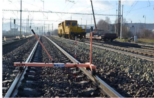
Obrázek 33: Topcon GPT-9003A [38] + Měřicí vozík GG-04 [39]
