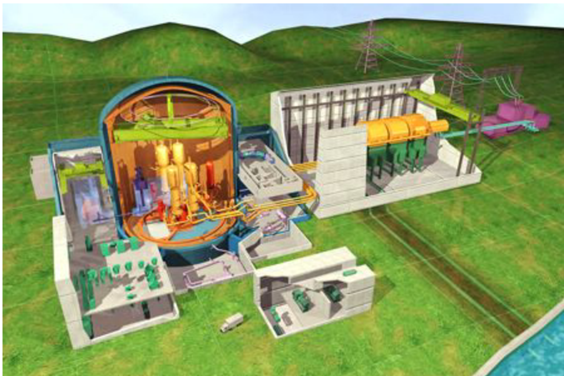
Obr. 9 Průřez elektrárnou s reaktorem EPR [20]
