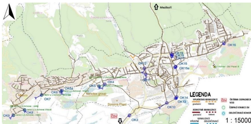
Obr. 14: Kanalizační systém Litvínov (zdroj: Kanalizační řád Litvínov)
