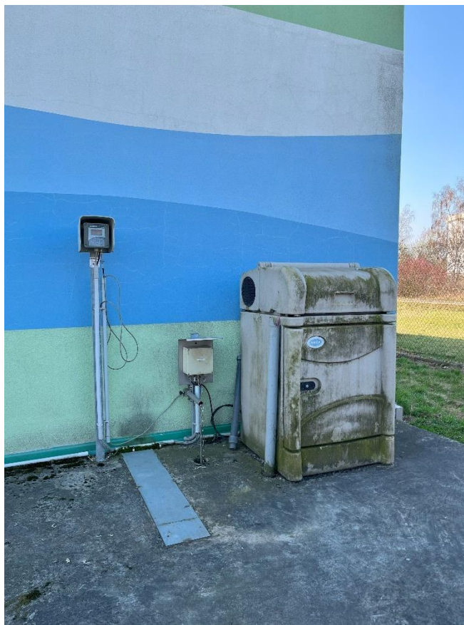
Příloha 7: Vzorkovací místo z nátoků na ČOV Litvínov s pH sondou (zdroj: autor).
