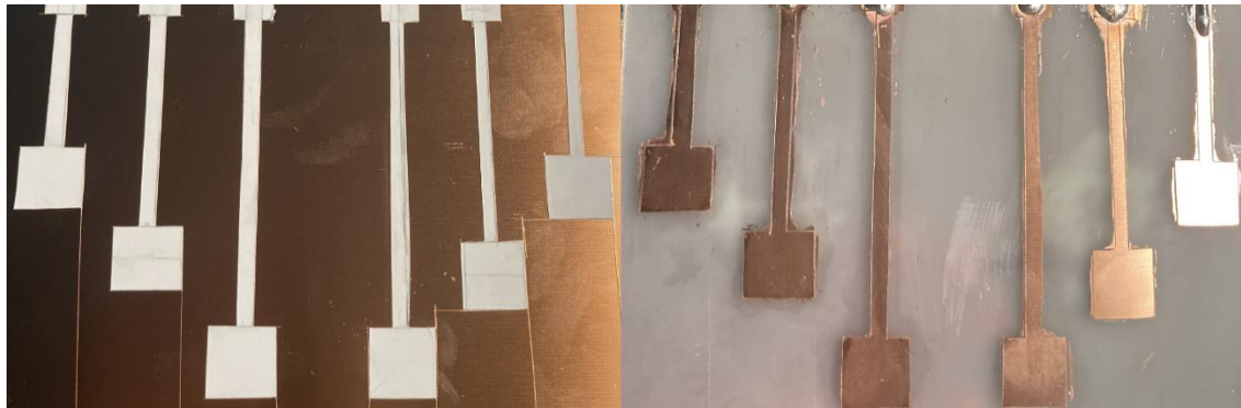
Obrázek 3.2 Leptání vodivých ploch crackleboxu
