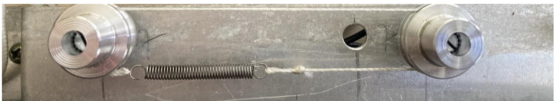
Obrázek 3.9 Mechanicky spojené stereo potenciometry
