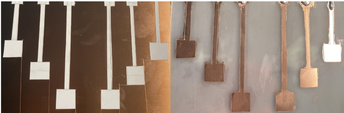
Obrázek 3.2 Leptání vodivých ploch crackleboxu
