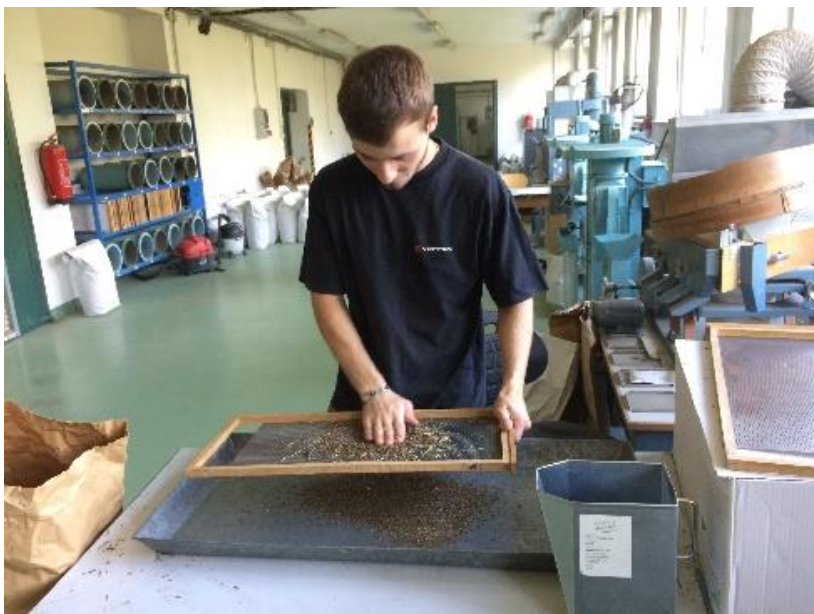
Příloha 5: Prosívání semen jetele na jemném sítu v podniku DLF-TRIFOLIUM Hladké Životice, s.r.o.
