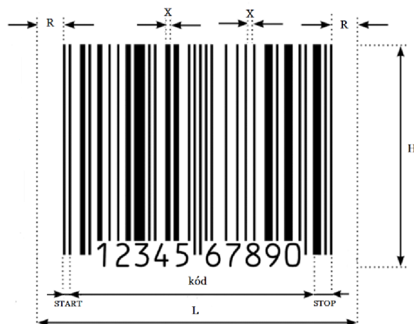
Obrázek 3: Konstrukce čárového kódu (Zdroj: Vlastní zpracování dle (32))
