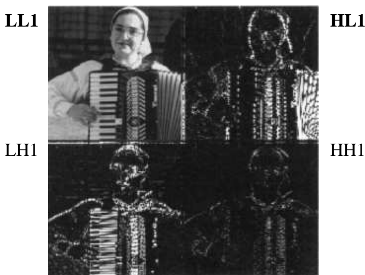
Obr. 6. První stupeň diskretní vlnkové transformace [2].
