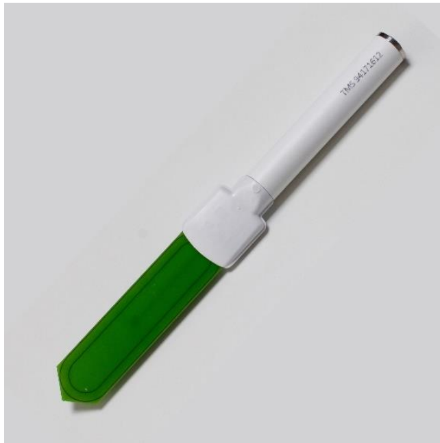
Obrázek 7 Vlhkostní senzor TMS4.
