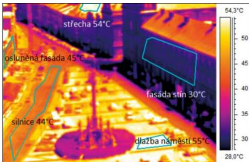
Obr. 15b: Termovizní snímky v Hradci Králové: Osluněné střechy mají teplotu až 54 °C, dlažba náměstí až 55 °C, osluněné fasády domů 45 °C a fasády ve stínu 30 °C.
