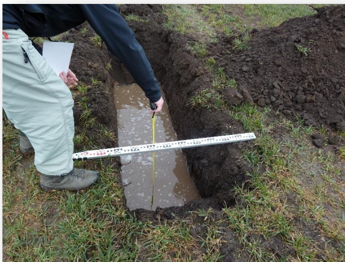
Obrázek 18: Ukázka zasakovací zkoušky průlehu cesty
