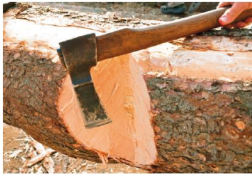
Obr. 16: Vrubování a hrubování hlavatkou (Kloiber, 2021)
