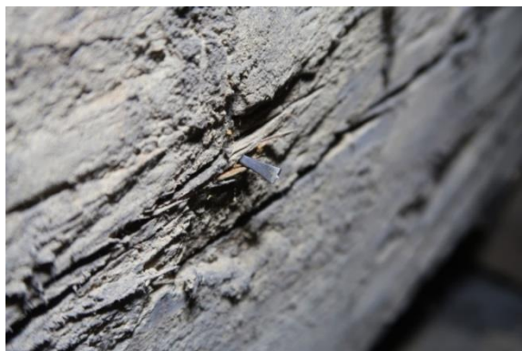
Obr. 18: Ocelová špička wolframového vrtáku
