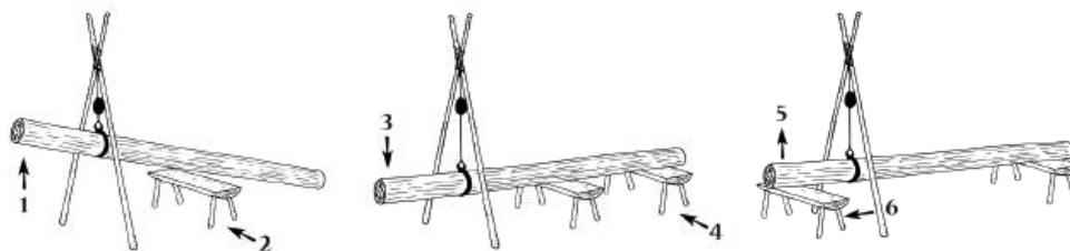
Obr. 15: Zvedání kulatiny na kozy pomocí dvojnožky a řetězového zvedáku (Kloiber, 2021)
