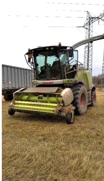
Obrázek 2.4: Sklízecí řezačka Claas Jaguar 940 (foto: Autor)
