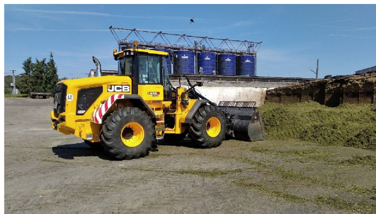
Obrázek 2.6: Rozhrnování a dusání senáže pomocí nakladače JCB (foto: Autor)
