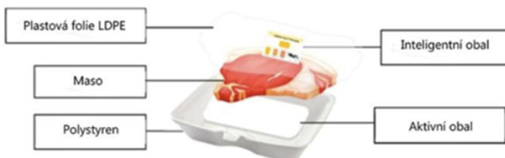
Obrázek 3: Schéma kombinace inteligentního a aktivního balení masa (Dirpan et al. 2022).
