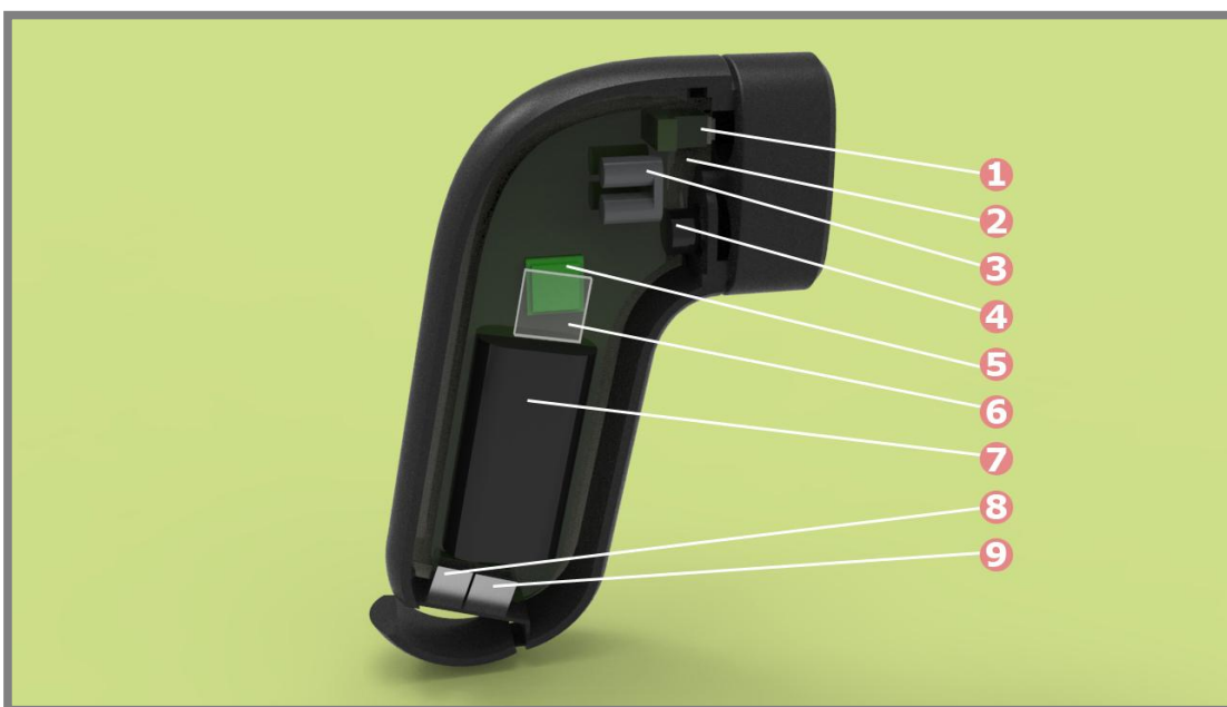
Obr. 24 Schéma umístění vnitřních částí videokamery
