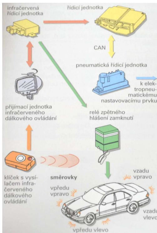
Obr.22 Systém s infračerveným dálkovým ovládním
