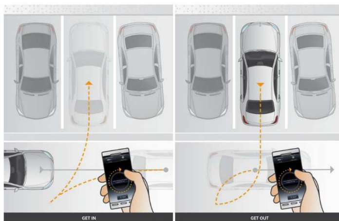
Obr.5 Dálkově ovládaný parkovací pilot
