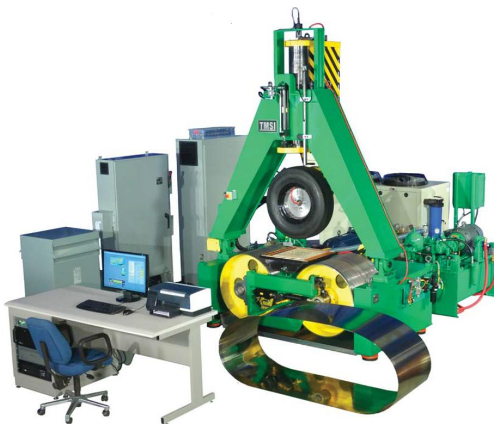
Obr. 4.5 Měřicí stav OnLevel™ společnosti TSMI s příslušenstvím [50]
