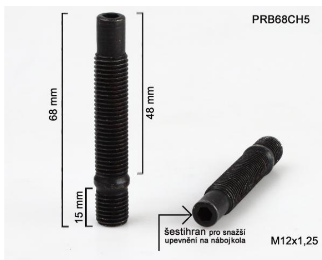
Obr. 5.2 Kolový svorník pro přišroubování distanční podložky [52]
