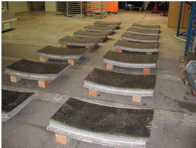
Obr. 4.2 Kazety měřicího zařízení institutu BASt s nanášeným povrchem používaným na silničních komunikacích [30]
