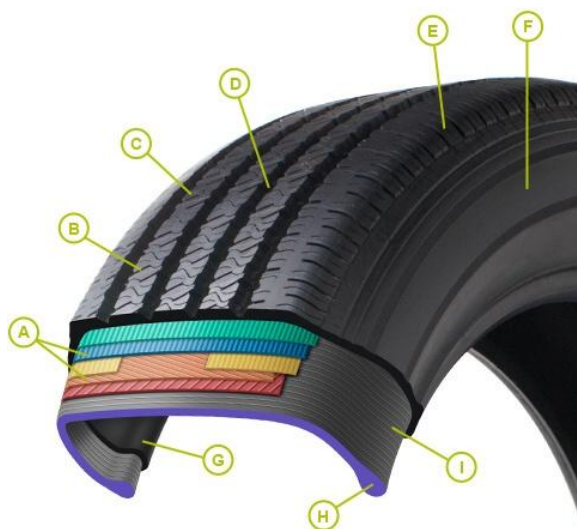
Obr. 2.1 Konstrukce pneumatiky: A – pásky (nárazníky), B – příčné drážky běhounu, C – běhoun, D – podélné drážky běhounu, E – rameno, F – bočnice, G – vnitřní vrstva, H – patka, I – kostra [40]
