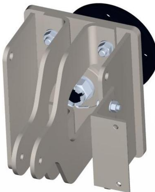
Obr. 6.20 Model zavěšení kola s měřenou pneumatikou
