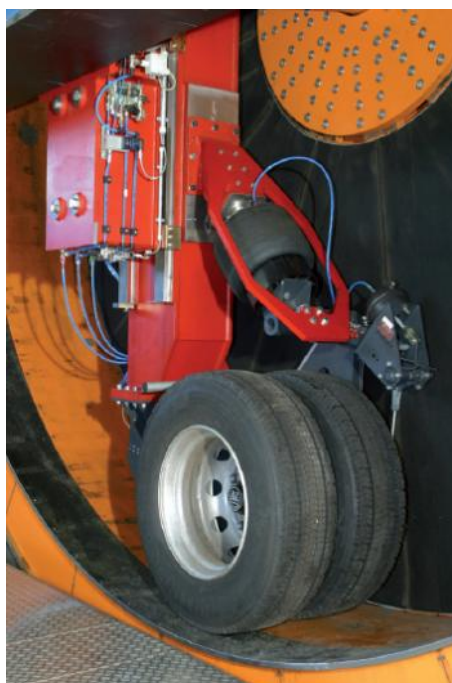
Obr. 4.4 Detail držáku kola s měřicí technikou pro měřicí stav institutu BASt [30]
