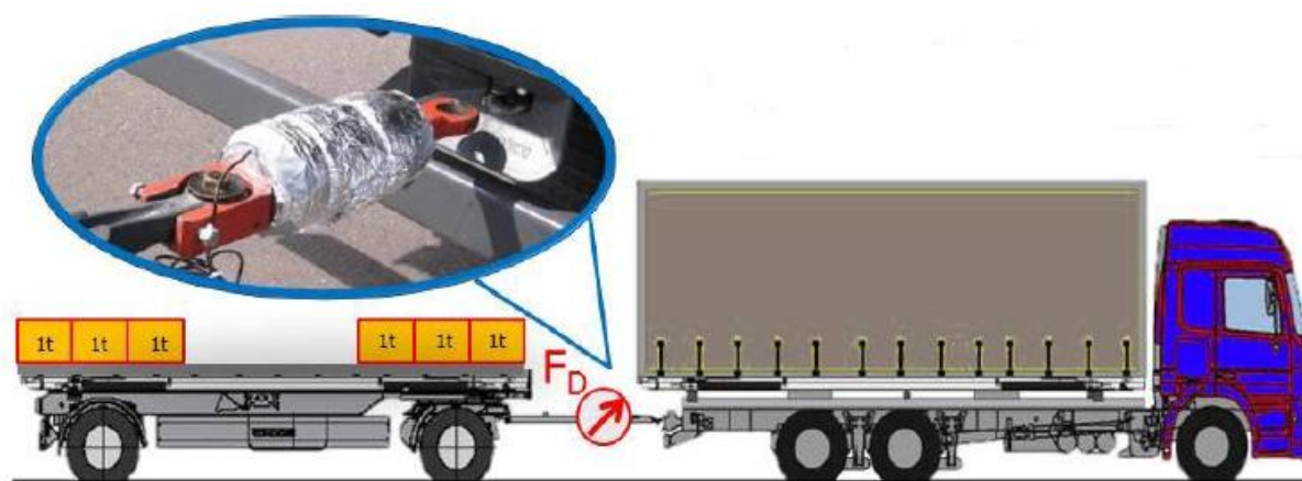
Obr. 4.10 Souprava organizace IPW pro měření valivého odporu nákladních pneumatik s detailem snímače síly [22]
