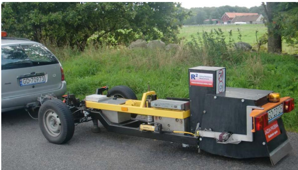
Obr. 4.7 Měřicí přívěs Technické univerzity v Gdańsku [44]
