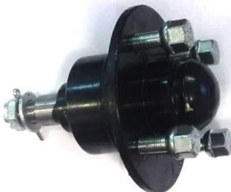
Obr. 5.1 Kolový náboj společnosti Maro Kralovice s. r. o. [78]
