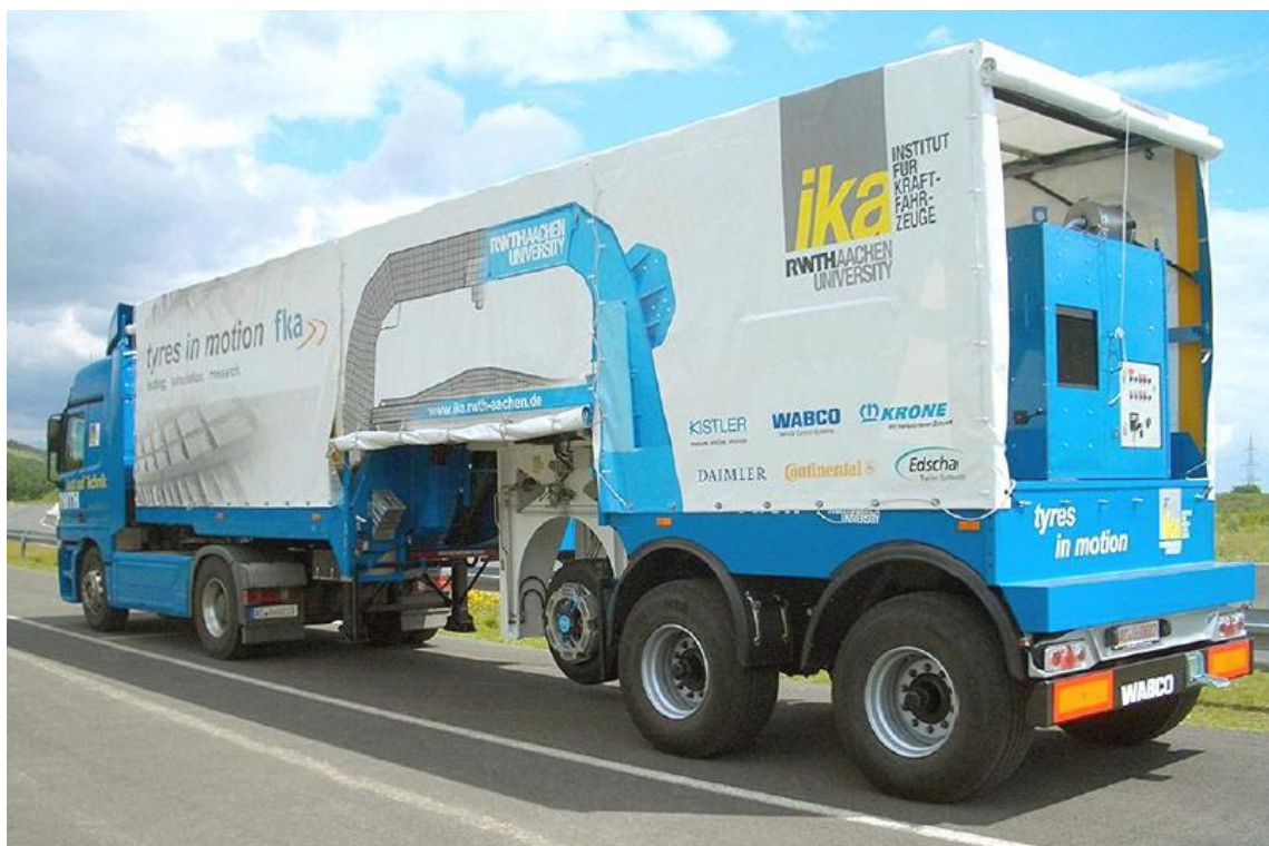
Obr. 4.9 Měřicí návěs sestavený Institut für Kraftfahrzeuge (ika) společně s RWTH Aachen University [44]
