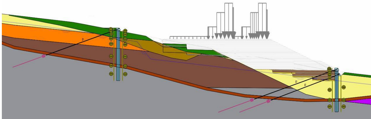
Obr. č. 31 - 1. Fáza – odťaženie, sanácia podložia, kotvená pilótovej stena
