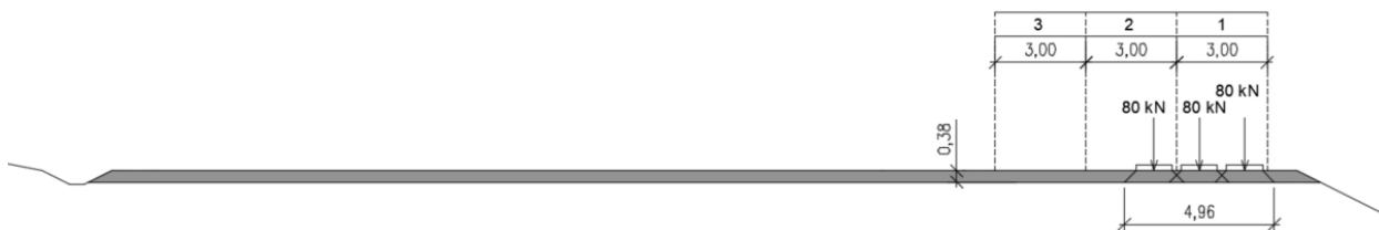
Obr. č. 19 - Roznos zaťaženia v priečnom smere pre model zaťaženia dopravou LM3
