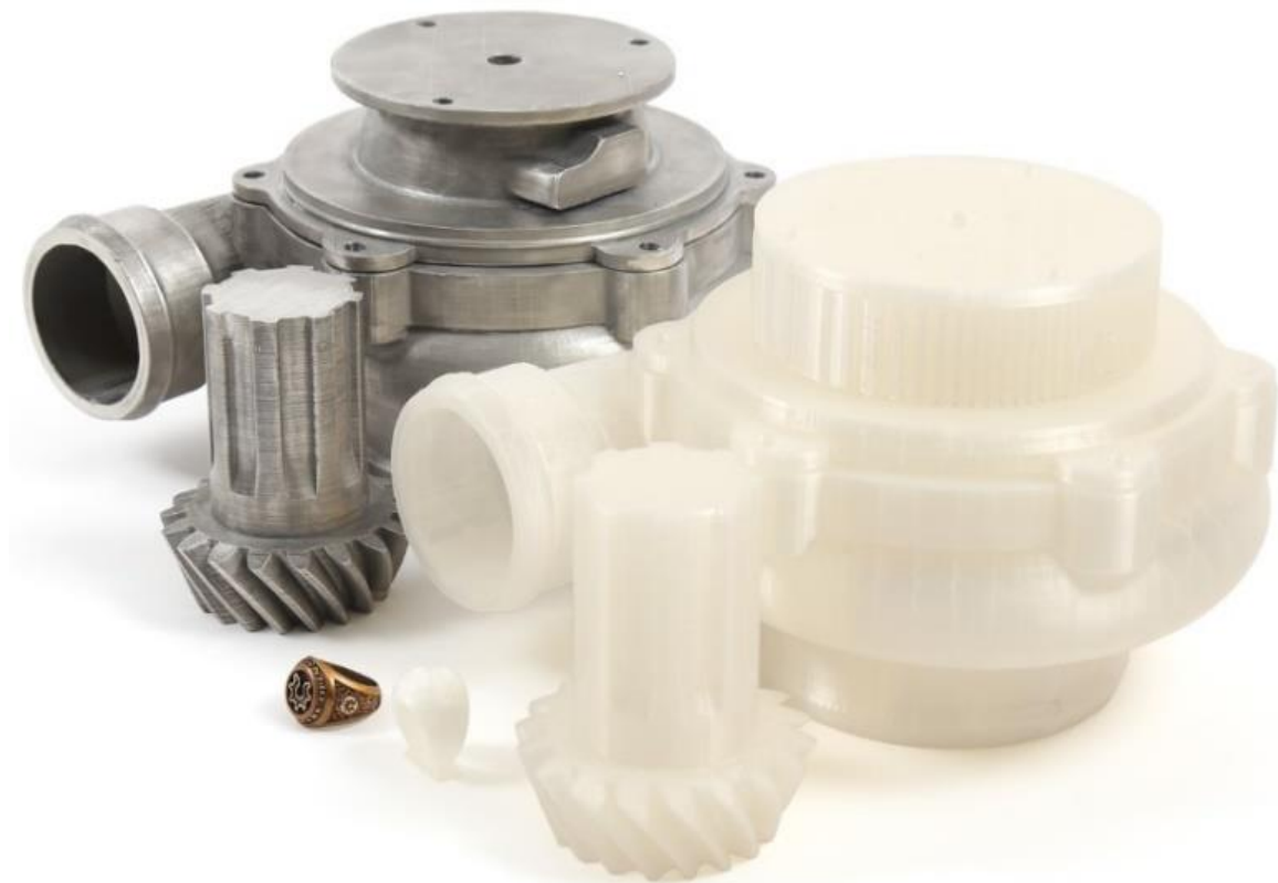
Obr. 1 Příklad 3D tištěných součástí [1].
