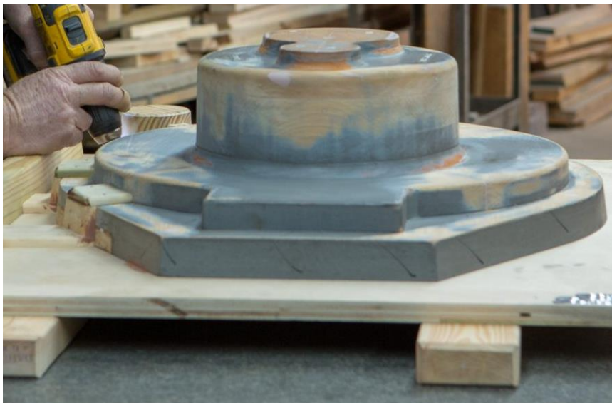
Obr. 3 Výroba dřevěného modelu [6].
