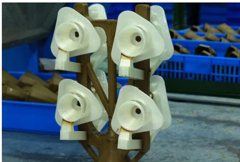
Obr. 8 Modely vytištěné z PolyCast™ materiálu [5].
