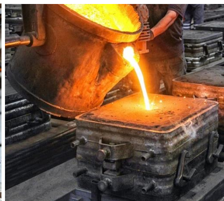
Obr. 5 Lití do netrvalé formy [8].
