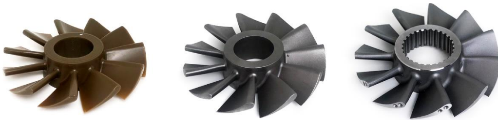
Obr. 6 Využití rapid prototyping při výrobě vrtulky. [13]
