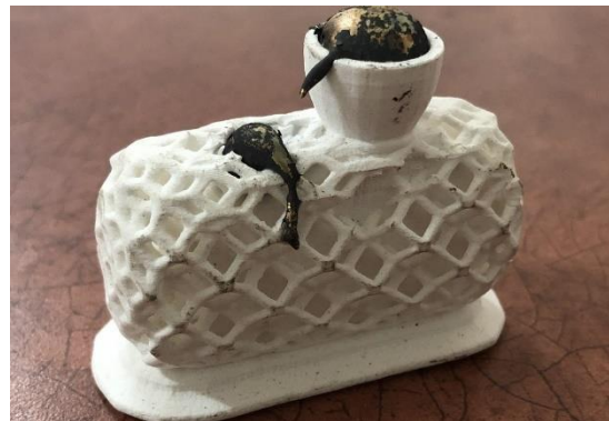
Obr. 11 Forma z Castalite materiálu [21].
