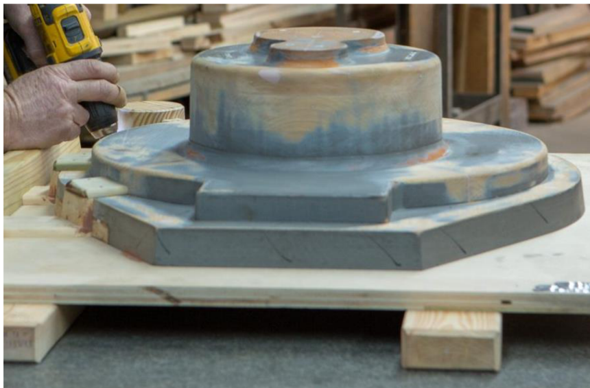
Obr. 3 Výroba dřevěného modelu [6].
