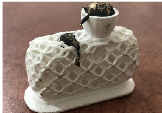
Obr. 11 Forma z Castalite materiálu [21].
