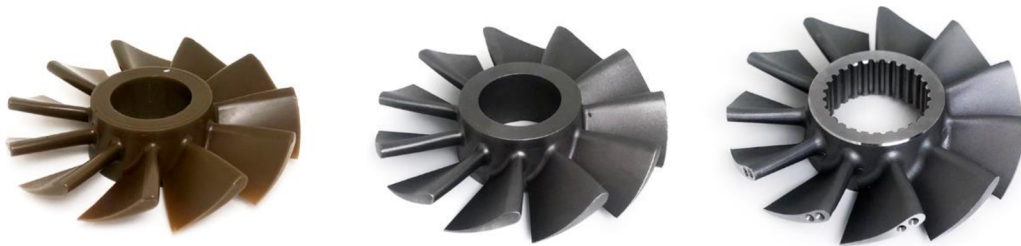
Obr. 6 Využití rapid prototyping při výrobě vrtulky. [13]
