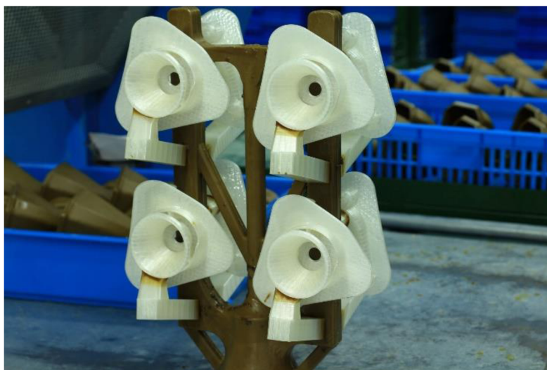
Obr. 8 Modely vytištěné z PolyCast™ materiálu [5].
